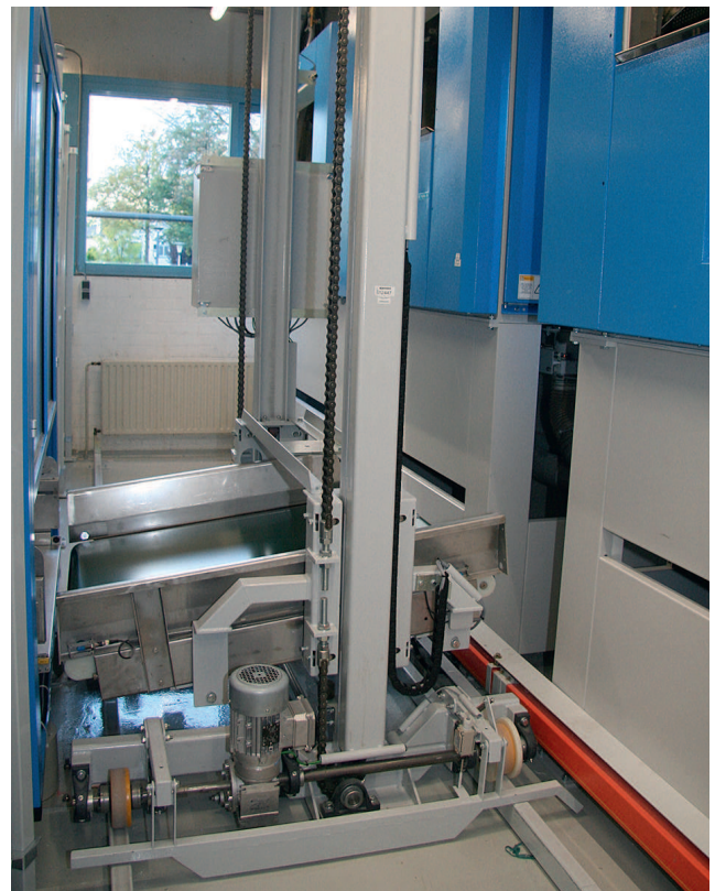
Ein automatischer Hubfahrwagen von WSP sorgt für unkomplizierten Wäschetransport. Schweres Heben durch die Mitarbeiter entfällt.
