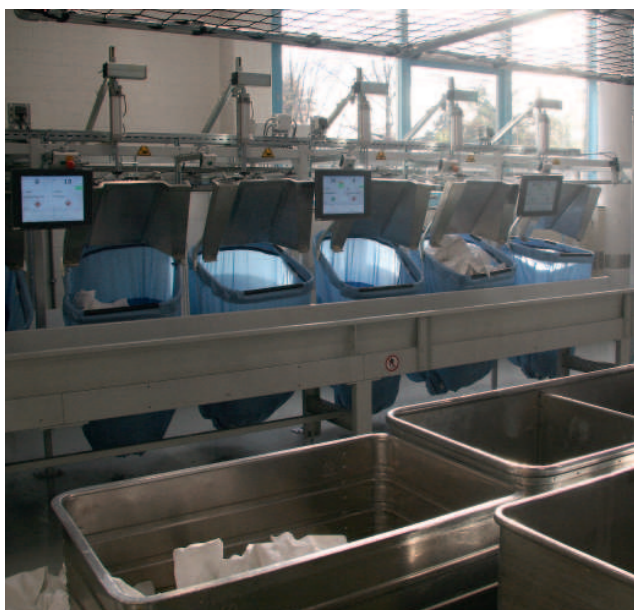
Hier erfolgt die Sortierung der Schmutzwäsche in Wäschesäcke. Die Monitor geben den Mitarbeitern eine Übersicht.
