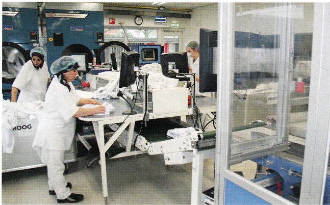
Im Hygienebereich falten die Mitarbeiter die Textilien manuell. Nur die Verpackung erfolgt mit einer Maschine.
